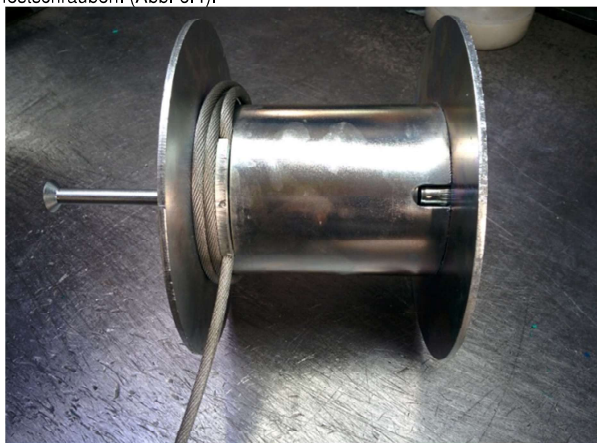
Abb. 6.4 8) Das Seil anziehen, bis es fest auf dem ganzen Zylinder anliegt. 9) Das Seil Windung an Windung in aufeinanderfolgenden Lagen korrekt aufwickeln. 10) Das Stahlseil durch das Gegengewicht und die Aluminiumklemme führen. 11) Die Seilkausche durch die Hakenbohrung führen. 12) Das Seil erneut durch die Klemme führen und die Kausche in der entstandenen Schlinge festziehen. 13) Das Seil ziehen, bis alle Komponenten untereinander angezogen sind. Anschließend die Aluminiumklemme mit einer Presse oder einem anderen Werkzeug zusammendrücken. (Abb. 6.5) 14) Kontrollieren, ob der obere Umschalter anspricht, wenn das Gegengewicht gegen den Hebel stößt. 15) Die in Absatz 6 beschriebene Belastungsprobe durchführen und den erfolgten Seilwechsel in der TAB.2 eintragen
